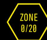
Arbeitsbereiche, in denen **zeitlich überwiegend** explosionsfähige Atmosphären in Form von brennbaren Gasen, Dämpfen oder Staubwolken herrschen (z.B. in Gastanks oder Getreidesilos)
